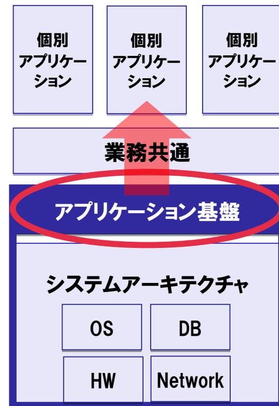
システム基盤のレイヤー構造例
